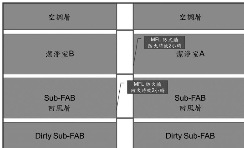
圖 3.7 潔淨室 MFL 防火牆位置側視圖(Site View)
